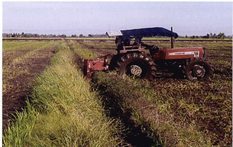
Gambar 1. Bajak subtanah getar/saluran buangan alur yang dipasang pada traktor 80 kk sedang membina alur buangan air yang bermula dari saluran
